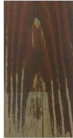
塗膜残存と脱落の混在
